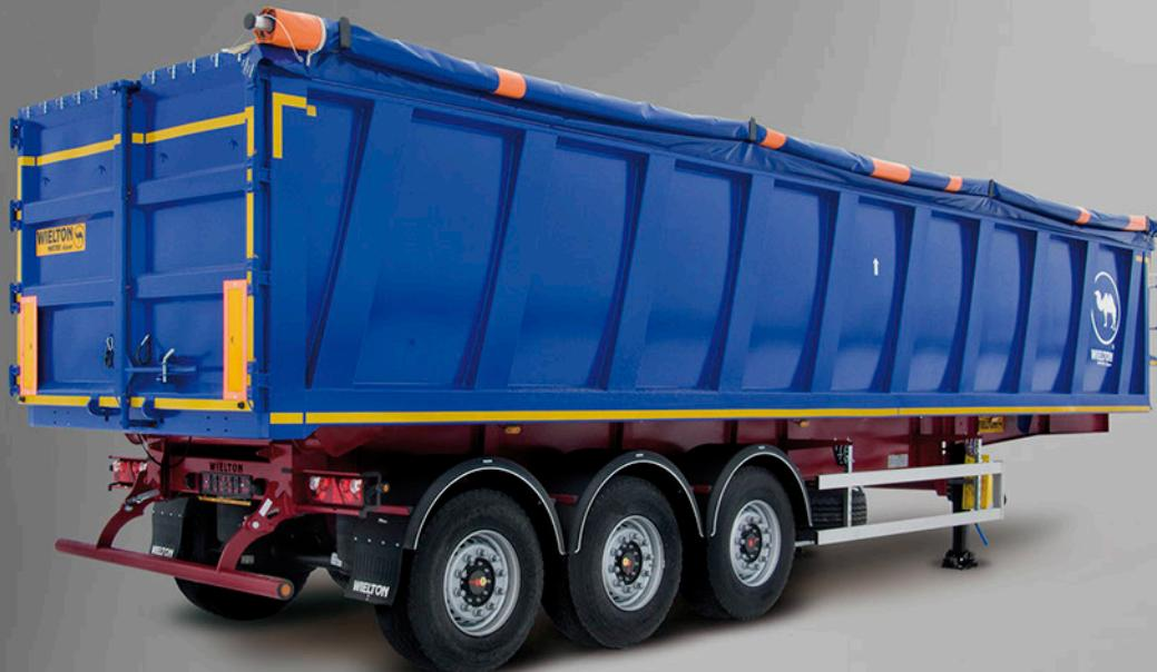
Полуприцеп-самосвал для перевозки металломолома изготавливается из стали DOMEX и HARDOX, которые характеризуются замечательными качествами по прочности и увеличенной прочностью на истирание. Выполнение стен из одного листа стали по всей длине и ширине, отсутствие вертикальных швов, которые были преградой при разгрузке.
