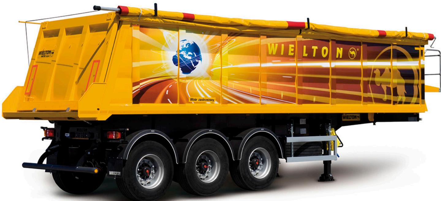
Специальная конструкция запрещённая патентом позволяет изготавливать стенки кузова из цельного листа металла, что значительно влияет на прочность и износостойкость кузова.
