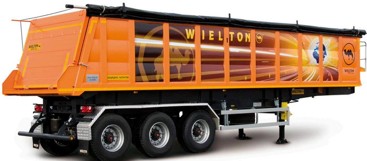
Новая, более прочная конструкция кузова. Специальное исполнение гидравлической системы и более современные виды масла дают возможность работы в условиях низких температур до -50°C.
