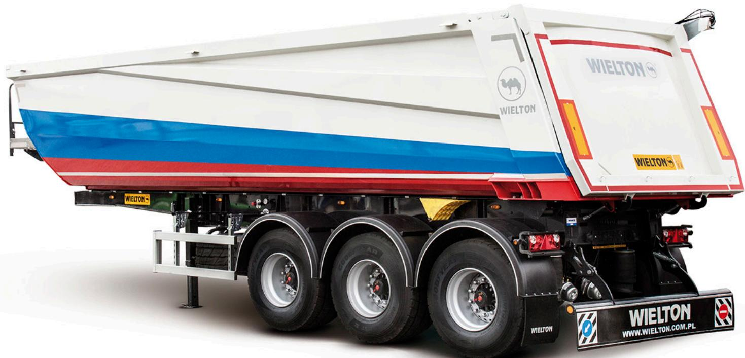
Новая инновационная конусная конструкция кузова значительно улучшает схождение груза, а также позволяет перевозить грузы на паллетах.
